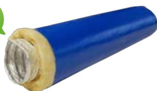
**SPIREO :** Conduit souple renforcé, intérieur aluminium/polyester et pare-vapeur en PVC. Épaisseur d'isolant 25 mm. 2 diamètres disponibles : 80 mm et 125 mm.
