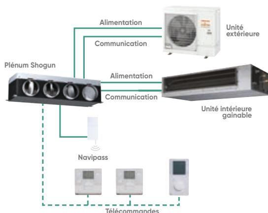
Shogun offre la possibilité de piloter jusqu'à 8 zones, via une sonde centralisée située dans la pièce principale et des sondes simplifiées placées dans toutes les autres pièces.
