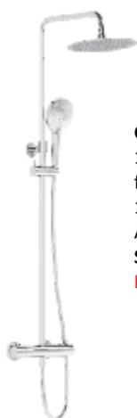
**Colonne de douche AQUAHEAT BLISS** avec pomme de tête inox Ø 250 mm, 12L/M, canne télescopique de 75 à 480 mm, mitigeur thermostatique corps froid, poignées en métal et butée de température à 38°, douchette à main Ø 120 mm avec sélecteur 3 jets 9L/M, flexible lisse anti-torsion 175 mm
