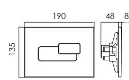
Plaque de commande double touche 3/6 L, non interrompable. Commande par l'avant. En matière synthétique ou plexiglass, stable aux UV.
