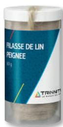
Filasse de lin pour l'étanchéité des raccords filetés métalliques. Pour rendre étanche les raccords filetés métalliques, par exemple pour des installations d'eau (froide et chaude), des installations de chauffage central, des installations d'air comprimé. À utiliser en combinaison avec la pâte d'étanchéité TRINNITY pour les installations d'eau. Ne convient pas à l'oxygène.
