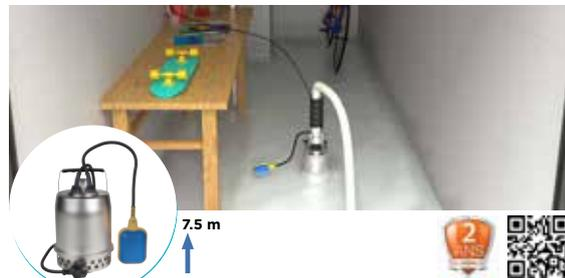
Sanisub Steel est une pompe vide-cave conçue pour le relevage d'eaux claires faiblement chargées : bassins, cuves et caves inondées, jusqu'à 7,5 m avec une granulométrie de 10 mm pour une température maximale de 70 °C. C'est une pompe en acier inoxydable avec refroidissement optimisé.
