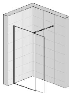
Paroi fixe + Volet pivotant positionné à 180°
